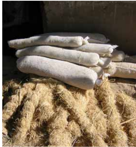
Dämmung mit Strohwürsten
